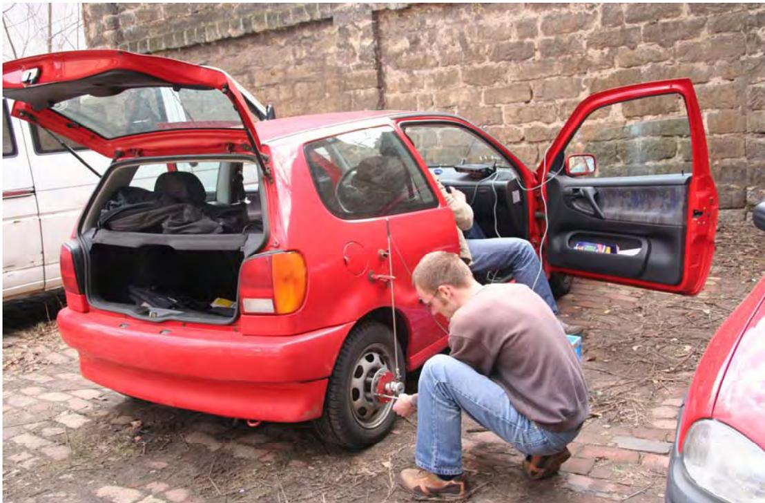
Foto: Montage des Peisler-Rades am Meßfahrzeug
