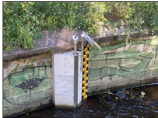
Abb. 7: Messstelle Prißnitz FP 2; Pegellatte, Drucksonde und Stromversorgung über Solar, 02.09.2021
