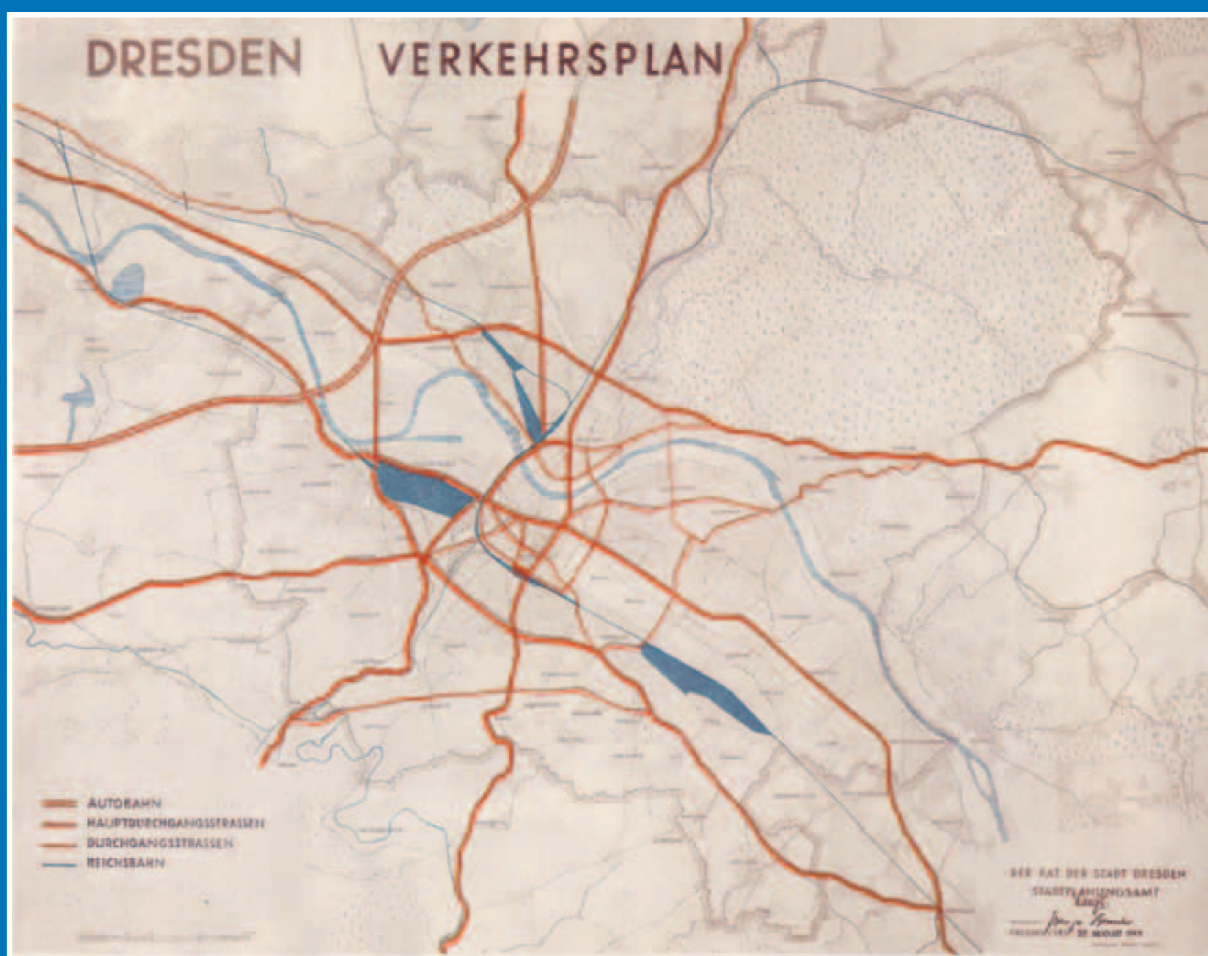
Das geplante Hauptverkehrsstraßennetz (HVS) der 50er Jahre. Erkennbar ist ein tangentialförmiges System, welches durch eine über die Elbe führende Querspange westlich des Stadtringes (26er Ringes) ergänzt wird.
