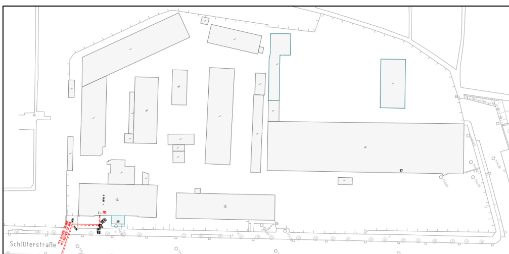
Abbildung 4 Ausschnitt Leitungsauskunft – Fernwärme
