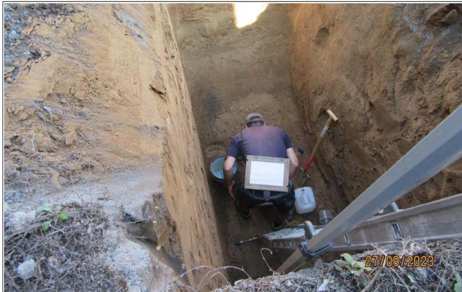
**Abb. 4:** Blick in Schurf 1 während des Versickerungsversuches SV 1
