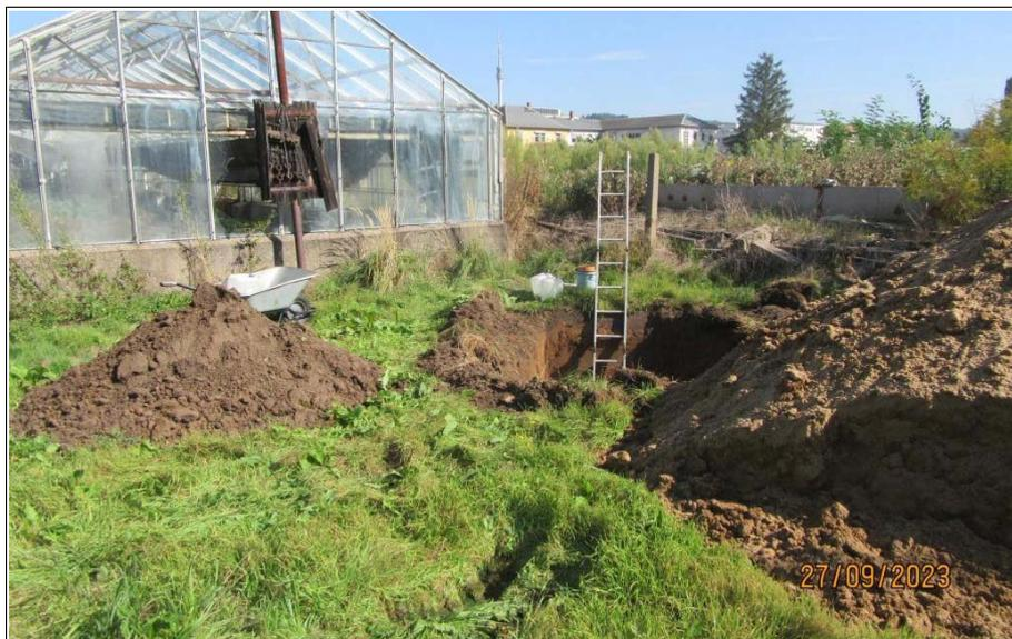
**Abb. 5:** Blick zum Schurf 3 nach Abschluss des Versickerungsversuches SV 3
