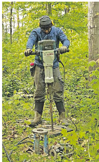
Ein Geotechniker bei der Bohrung hinter der Rennbahn. Hier soll der neue Radweg entstehen. Foto: Katja Schumann
